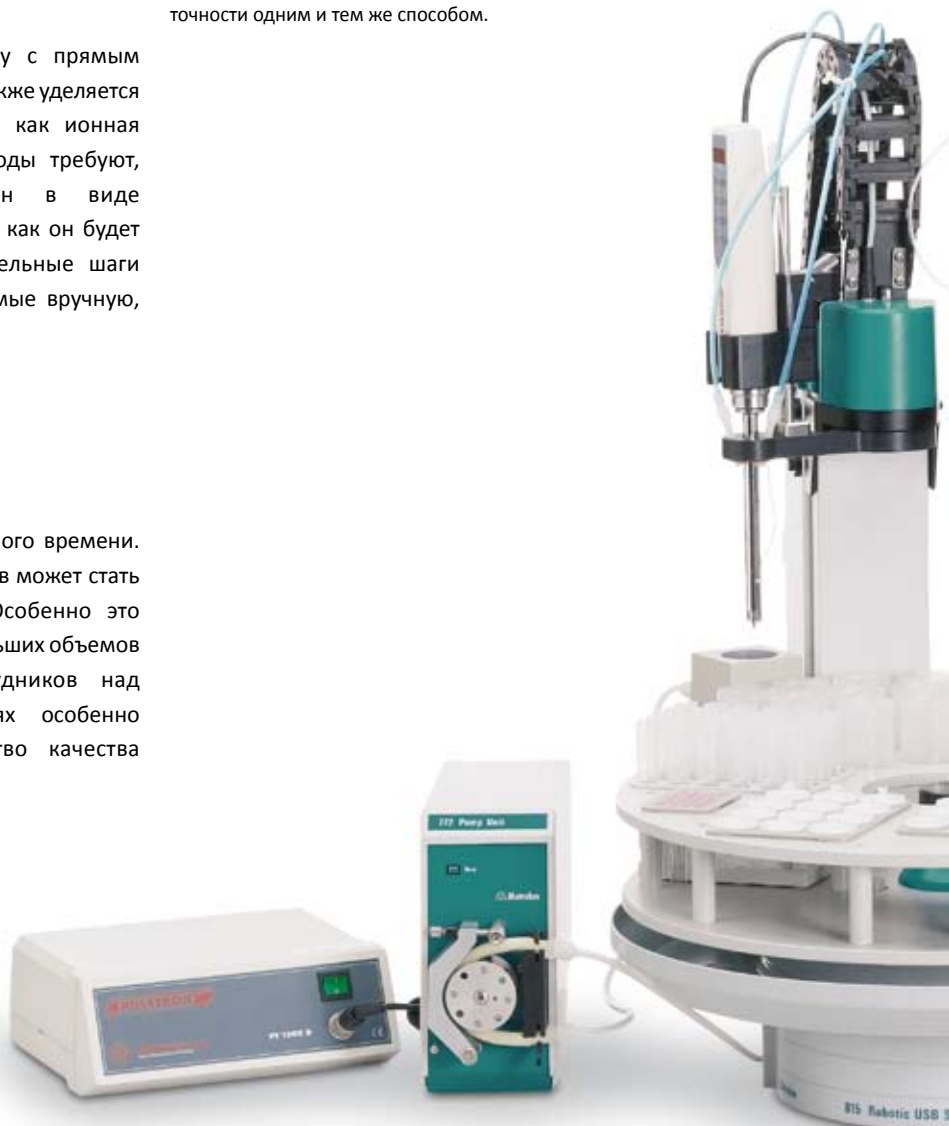
Система пробоподготовки с фильтрацией 815 Robotic Filtration Soliprep
