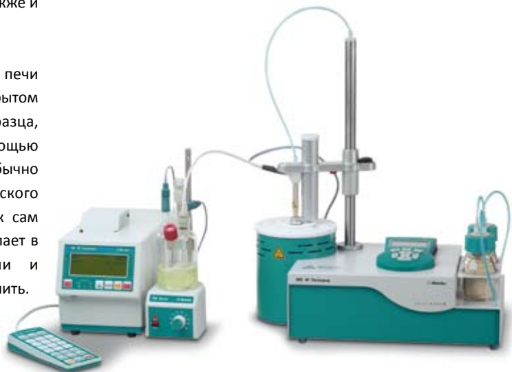
Печь 860 KF Thermoprep с кулонометром 756 Coulometer
