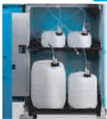
ADI 2040 во взрывозащищенном исполнении с отделением для реагентов
